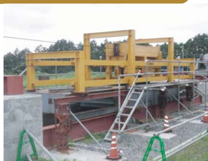
実物大鋼床版疲労試験
