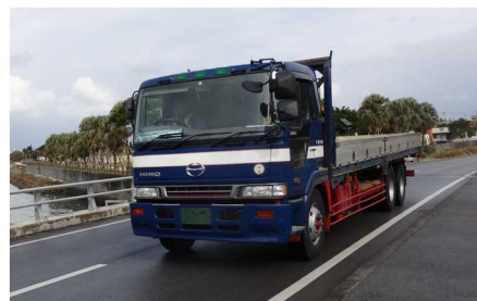
図4 荷重車走行状況(荷重 10.1ton)
